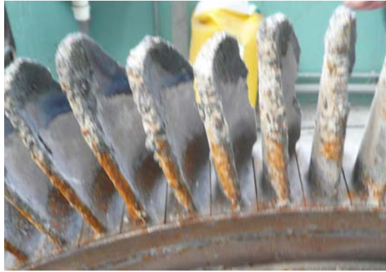
Roue de turbine HP brûlée
