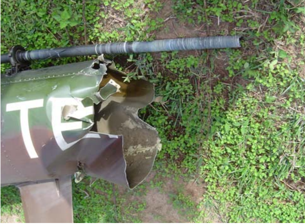
7. Rupture de la poutre de queue
