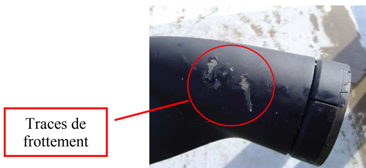
Détail de la perche
