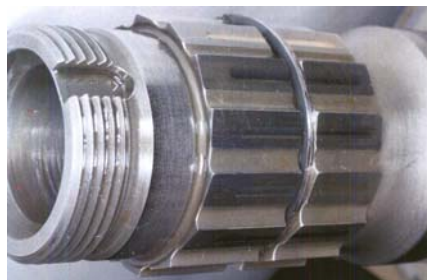
Vue rapprochée de la portée des rouleaux
