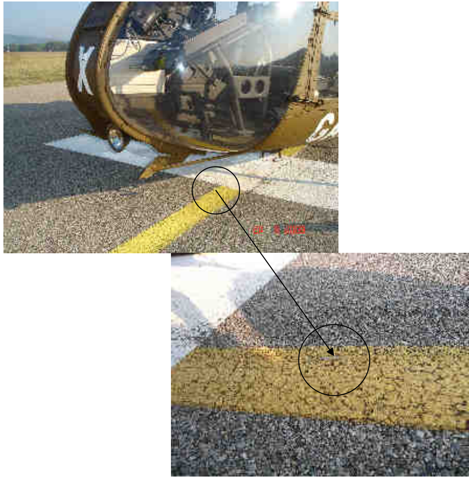
Vue n° 6 : trace d'impact au sol du coupe-câble avant
