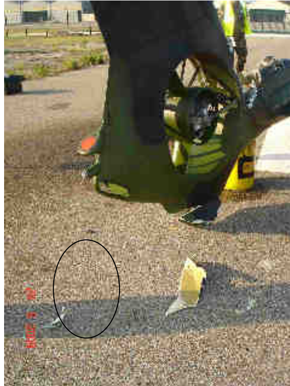
Vue n° 10 : érosion du sol à l'arrière droit du sabot.
