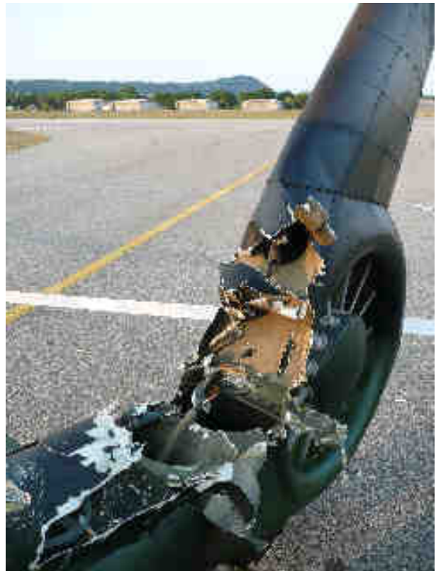
Positions relatives de la pale et de la dérive, en statique, pale libre
