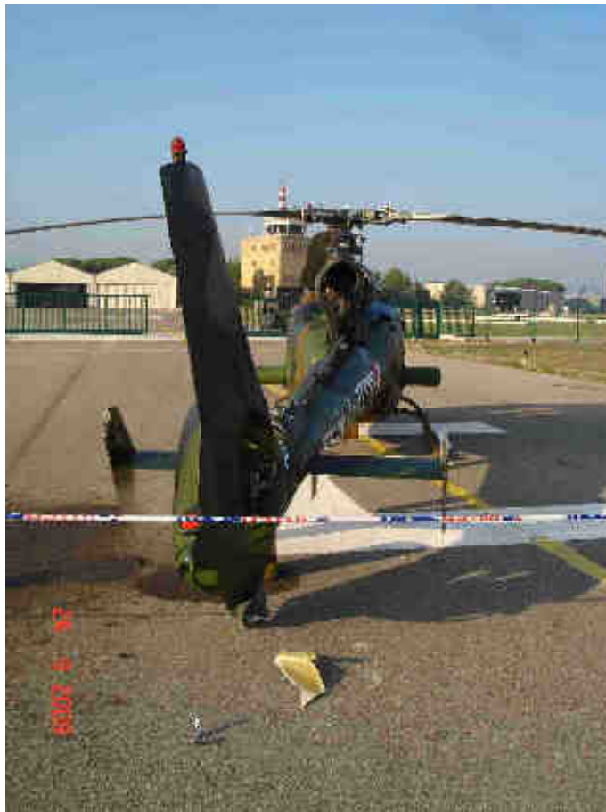
Vue n° 12 : vue du fléchissement vers la gauche de la poutre de queue
