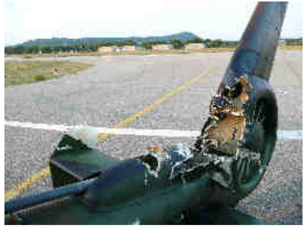
Vue n° 14 : endommagements provoqués par le rotor principal à l'arrière de la poutre
