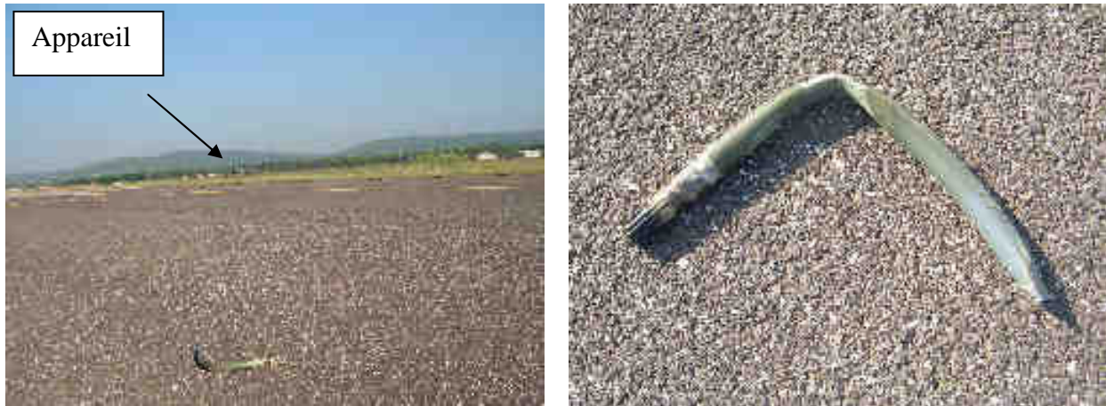
Vue n° 5 : morceau rompu de l'arbre de liaison RAC, côté boîtier de transmission arrière
