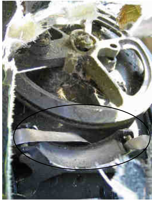
Vue n° 15 : ruptures de l'accouplement flector (à gauche) et du palier de la transmission RAC (à droite)
