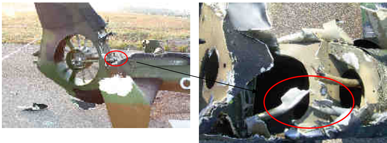
Vue n° 17 : sectionnement de la biellette de commande de pas RAC
