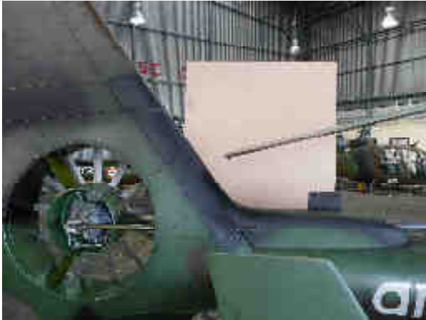
Positions relatives de la pale et de la dérive, en statique, pale libre
