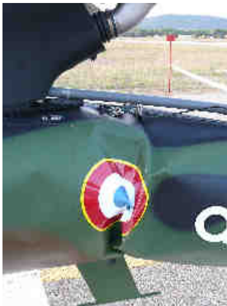
Vue n° 13 : déformations en flexion de la poutre de queue
