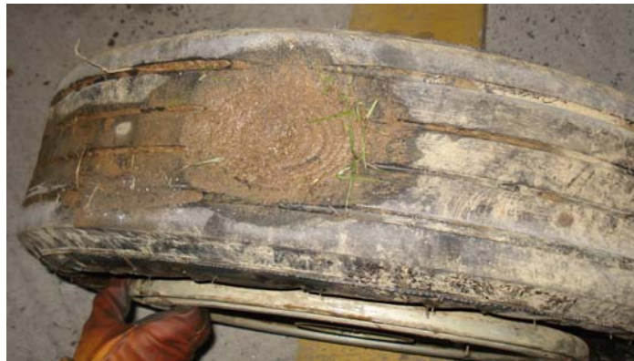
Vue de la roue gauche endommagée
