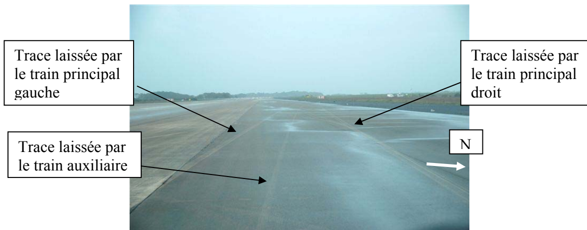
Vue des traces sur la piste (dans le sens de l'atterrissage)
