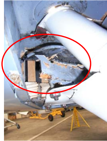
Endommagements du longeron de voilure et de la cale de train, vus de l'arrière
