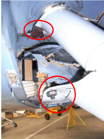
Endommagements des platines supérieures et inférieures de l'atterrisseur principal droit, vus de dessous et de l'avant
