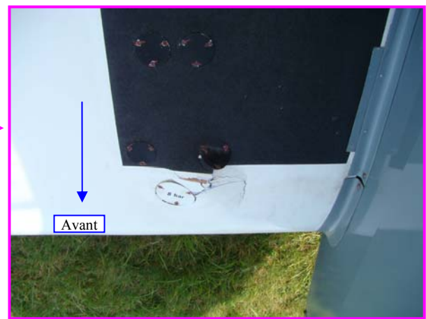
Endommagement de l'extrados de l'aile au niveau de l'atterrisseur principal droit vu de dessus
