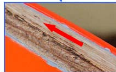
Sens des traces du frottement de la voilure sur le revêtement de la piste
