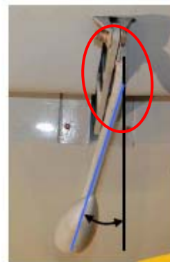
Déformation du bras du contreponds de l'aileron droit
