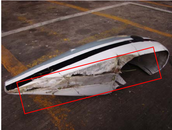
Vues présentant l'endommagement du carénage de la roue droite
