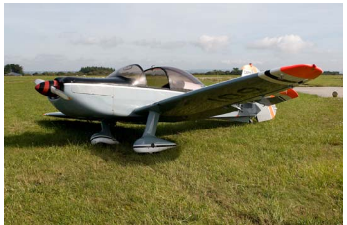
Vue de profil présentant l'affaissement du train « vers l'avant », avion posé au sol
