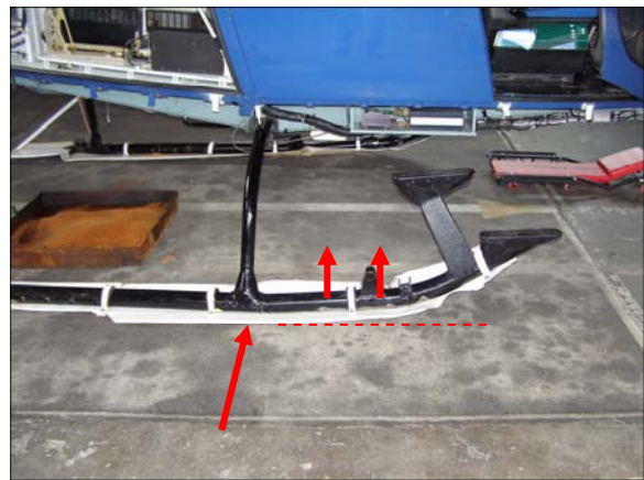
Vue de la déformation du patin droit
