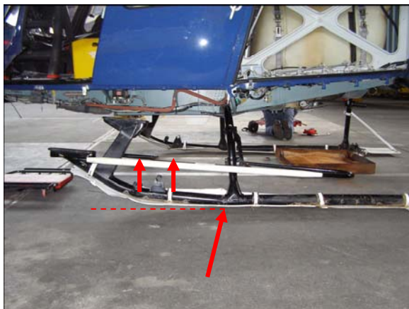
Vue de la déformation du patin gauche
