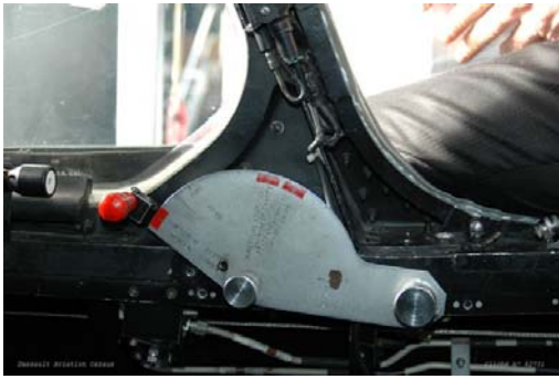
Levier sur la position verrouillage (butée avant)
