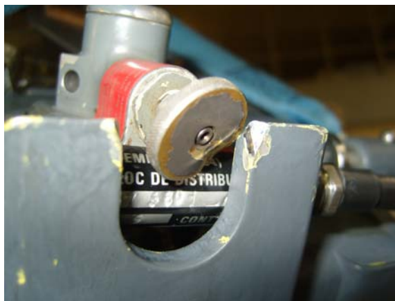
Figure 2 : bloc de distribution en partie supérieur du canon du siège éjectable (2)
