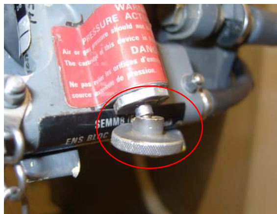
Figure 1 : bloc de distribution en partie supérieur du canon du siège éjectable (1)
