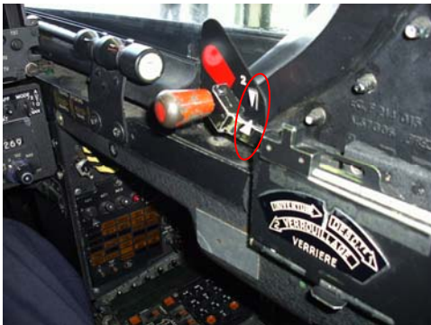
Index de positionnement : repères blancs alignés
