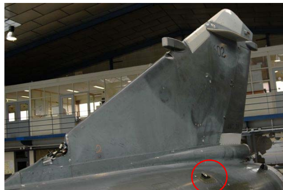
Figure 12 : impact écope gauche
