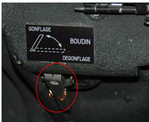
Vue de la manette de commande du robinet boudin, en position gonflage
