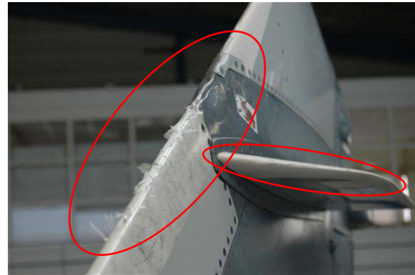
Figure 8 : impact 4 sur la dérive
