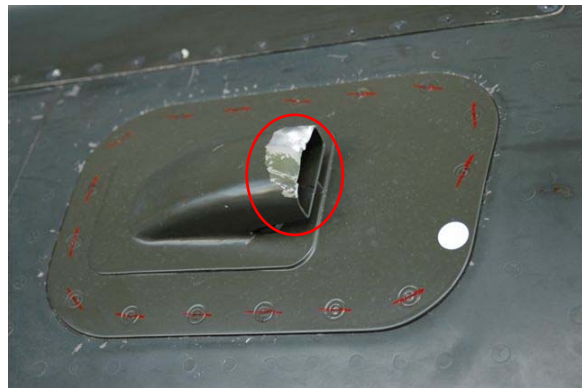
Figure 11 : impact écope droite
