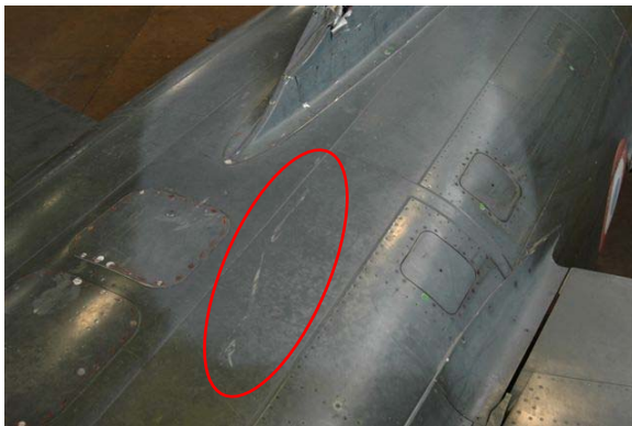
Figure 10 : rayures sur la partie supérieure du fuselage
