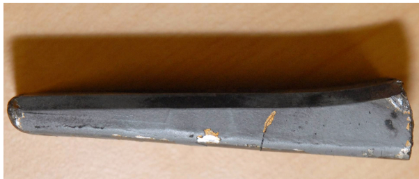
Partie arrière du talon de crosse du Rafale B325
