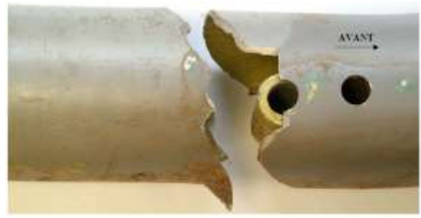
Figure 9 : vue côté extérieur de la rupture
