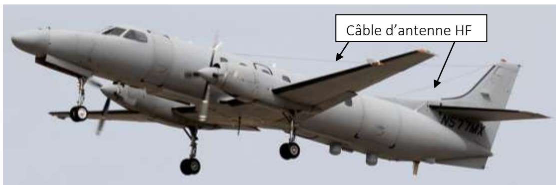
Figure 25 : positionnement du câble HF sur l'avion
