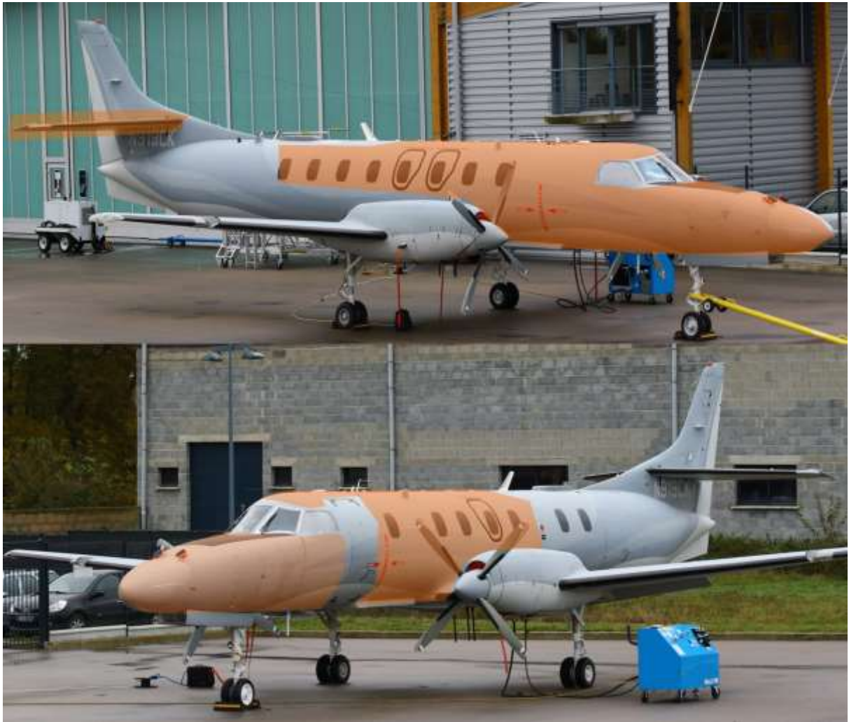
Figure 19 : illustration sur l'avion « jumeau » des éléments ou surfaces du fuselage absents (couleur orange)
