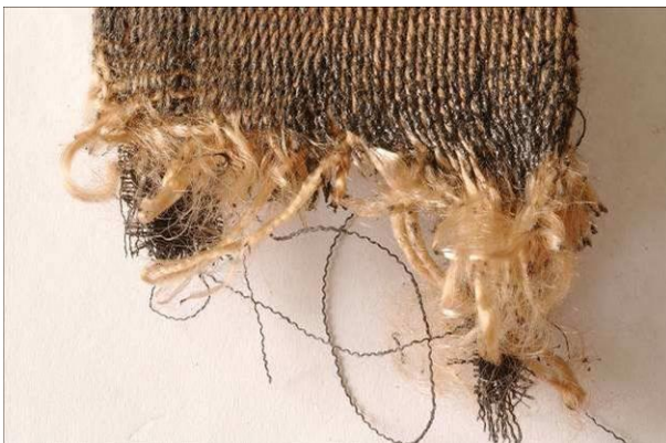
Aspect des fibres textiles échauffées à l'endroit de la rupture
