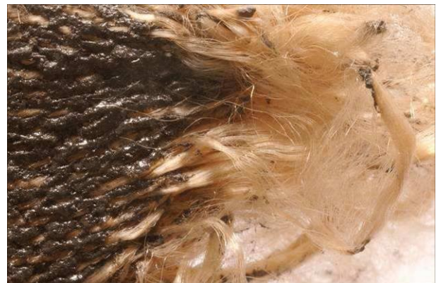
Aspect des fibres textiles échauffées à l'endroit de la rupture
