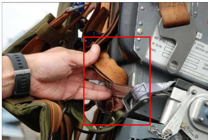
Positionnement du harnais sur siège MK10 et zone de rupture : aspect d'une sangle d'élévateur d'un harnais de 2008 et de la sangle de maintien
