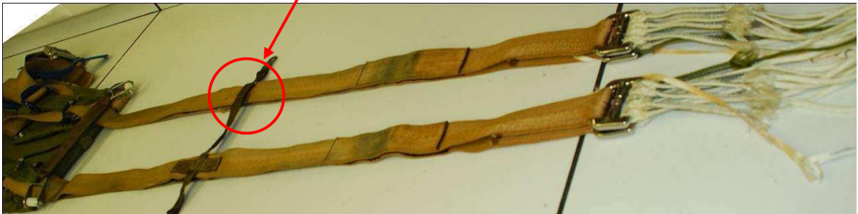
Localisation de la rupture de l'élevateur arrière droit
