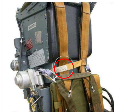
Positionnement du harnais sur siège MK10 et zone de rupture : aspect d'une sangle d'élévateur d'un harnais de 2008 et de la sangle de maintien
