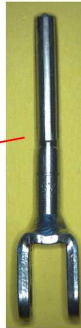
Rupture commande des gaz
