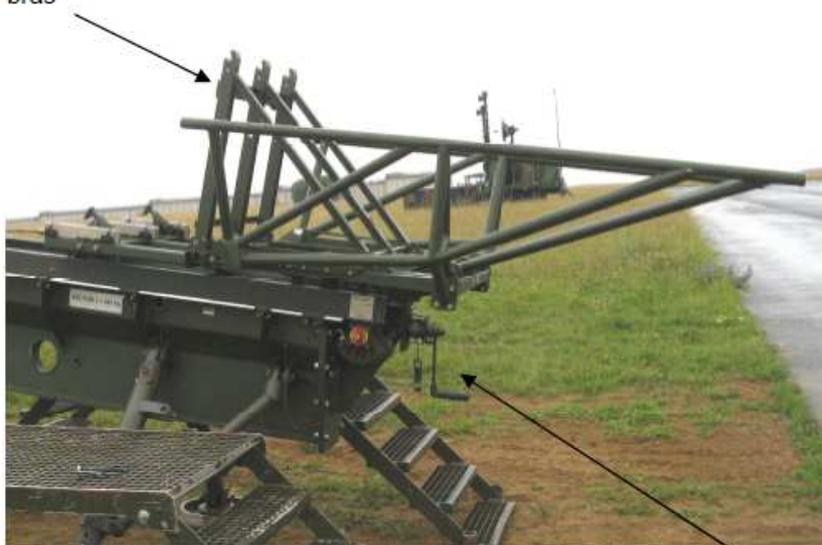
Manivelle du dispositif de treuillage
