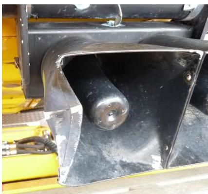
Dommages sur les haut-parleurs
