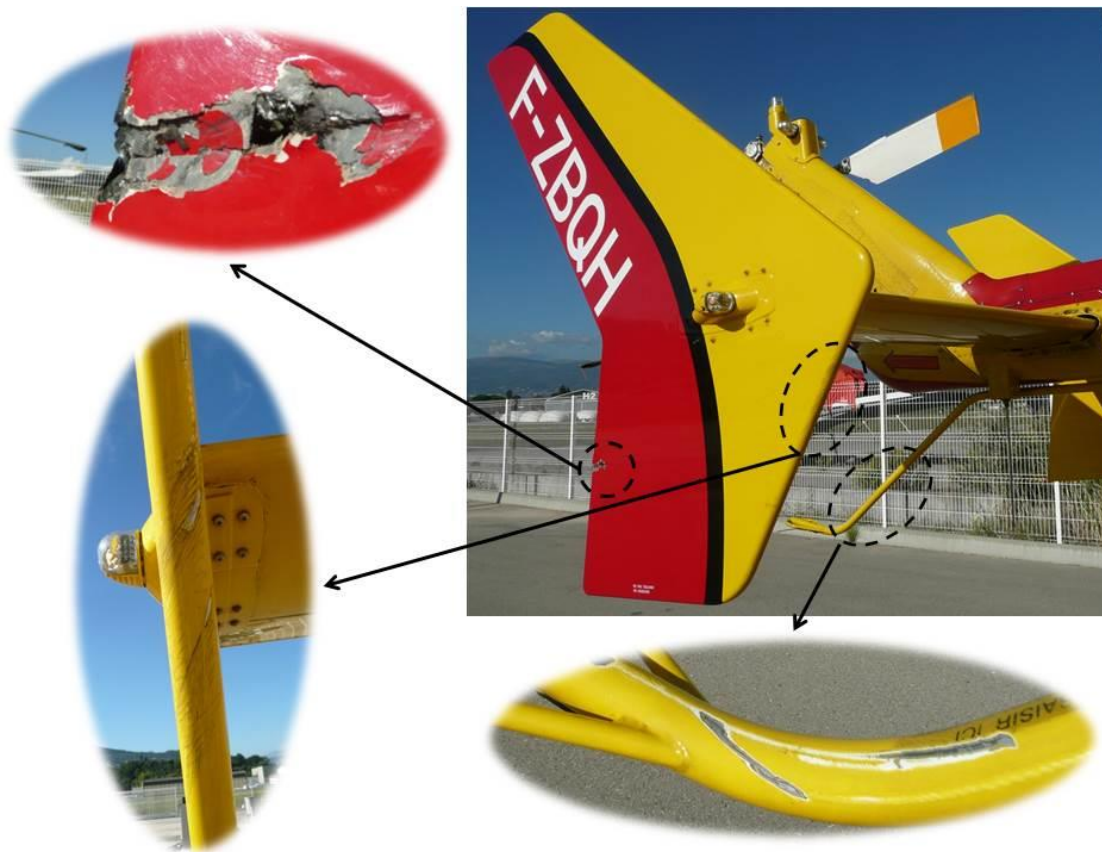
Dommages sur la partie arrière
