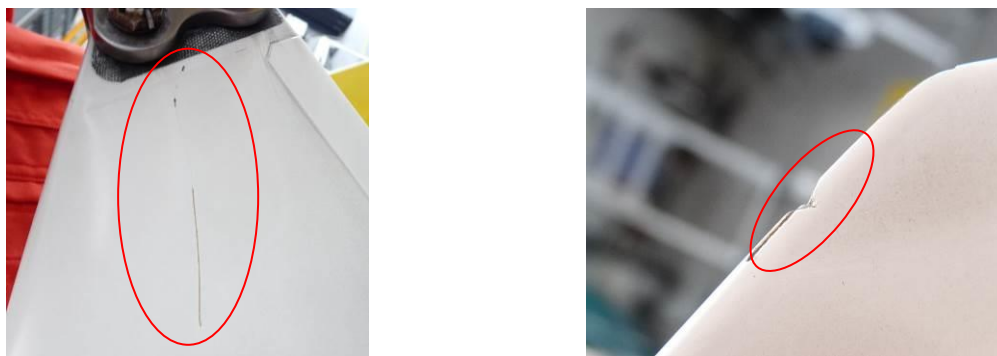
Dommages sur le rotor anti-couple
