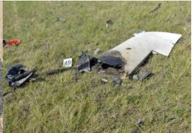
Vue de la partie rompue de l'aile droite
