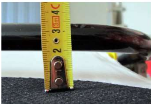
Position de la barre de manœuvre du siège un seul des deux pions verrouillés
