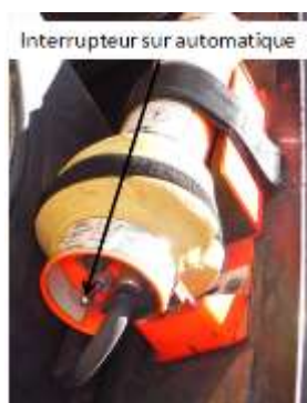
Balise de détresse
