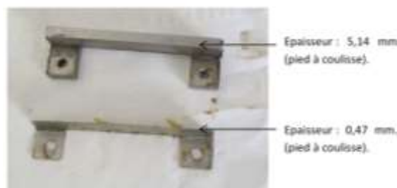
Vue d'une des cales supplémentaires installées sous la cale de réglage
