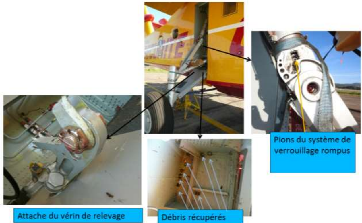
Vue des endommagements au niveau de la jambe de train droite
