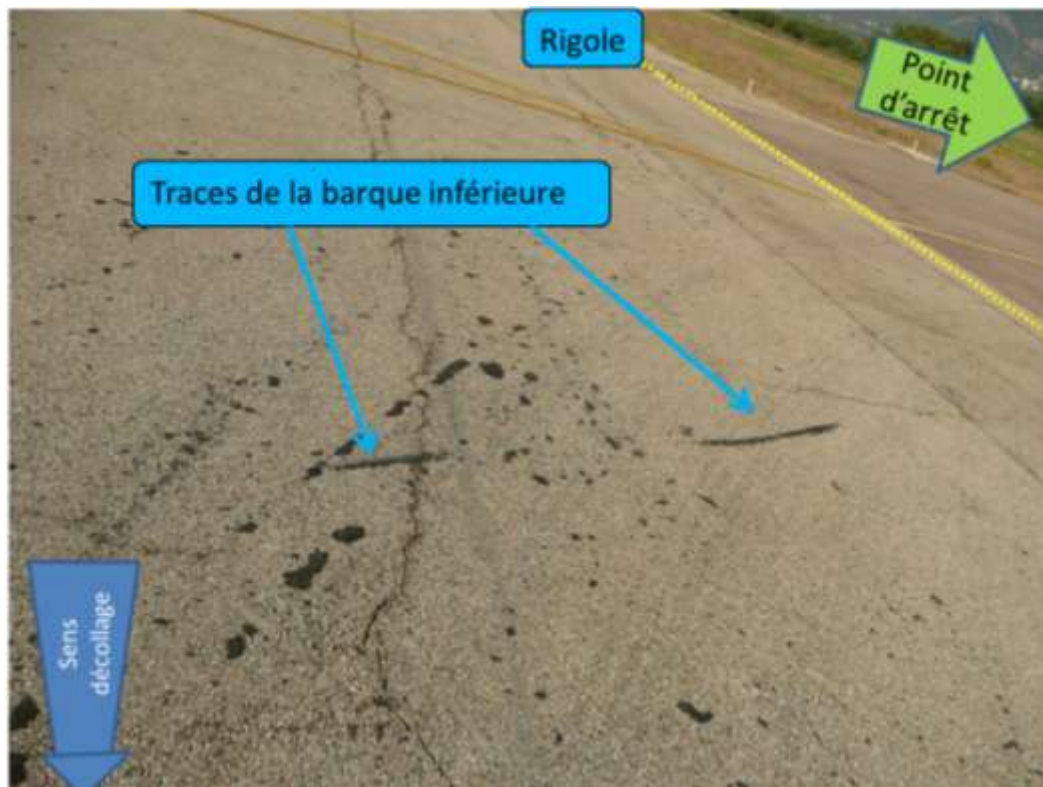
Vue détaillée des traces de contact de la barque inférieure
