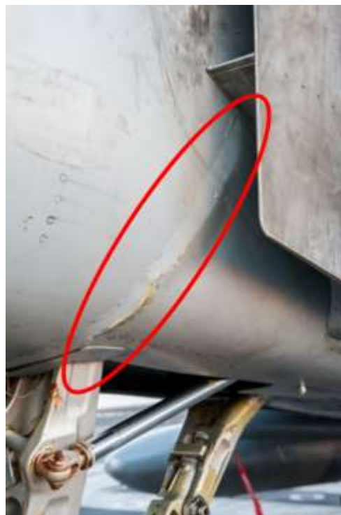
Déformation de la cellule
