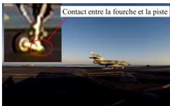
Vue du contact entre la fourche et la piste
