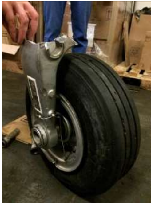
Vue de la partie de la fourche solidaire de la roue
