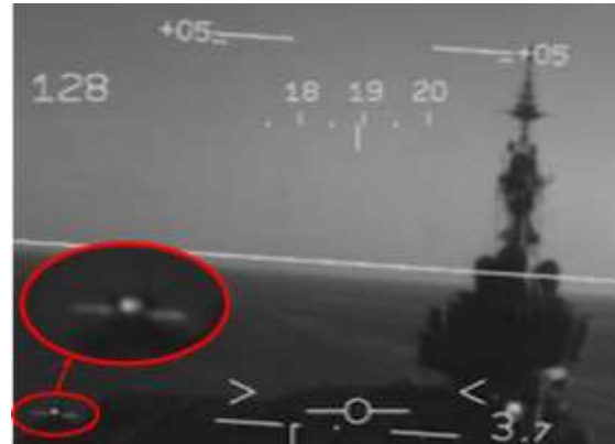
Indication du miroir d'appontage au moment de l'ordre « moteur, moteur, moteur »
