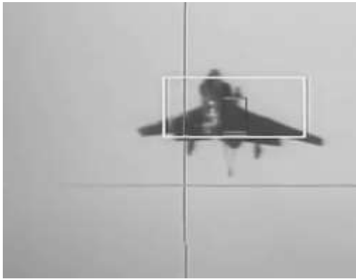
Position du SEM par rapport au plan recommandé au moment de l'ordre « moteur, moteur, moteur »
