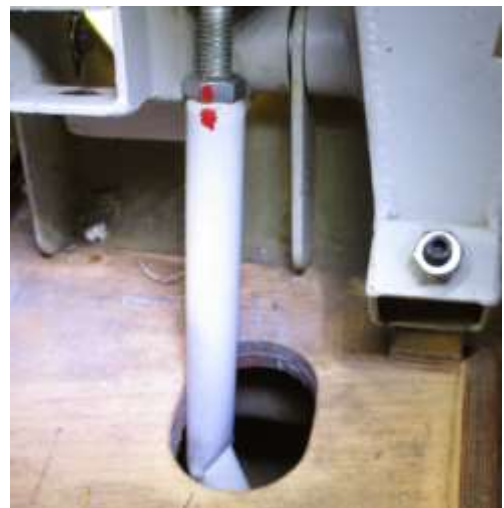
Vue des dommages d'une bielle oblique des commandes de gauchissement
