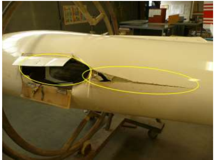
Vue du recul du train et de la déchirure du fuselage
