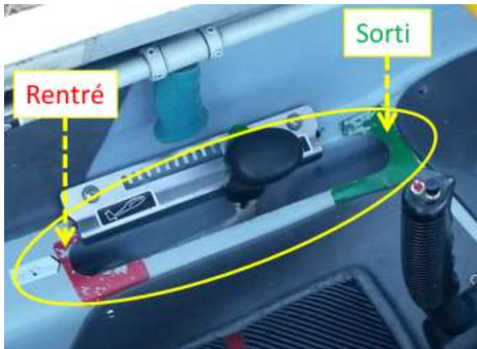
Vue du recul de la commande de train
