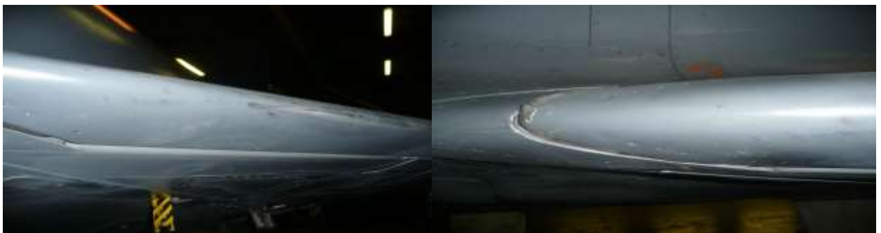
Bec interne gauche désaligné du bord d'attaque de la voilure
