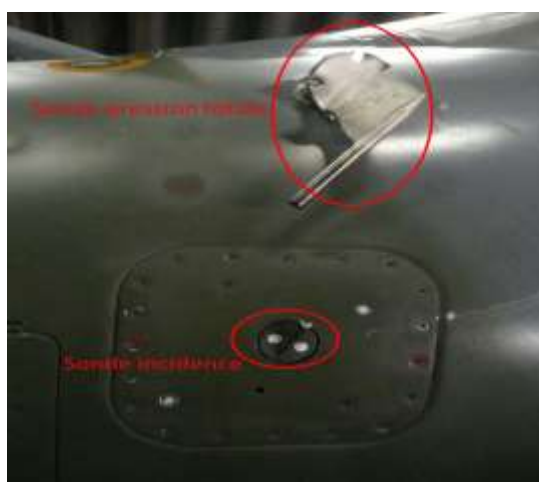
Sonde pression totale gauche arrachée et sonde incidence gauche cassée
