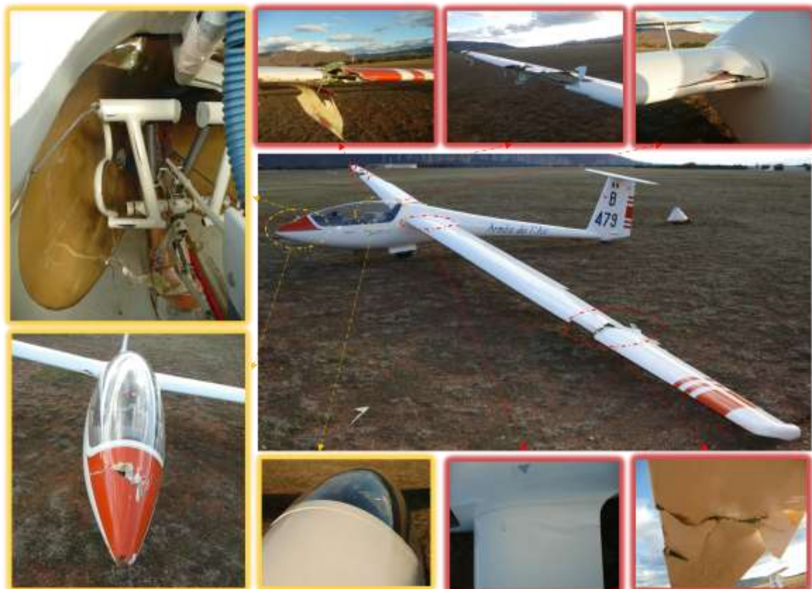
Vues des dommages au planeur
