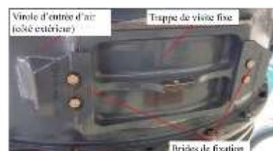
Figure 11 : Trappe fixe verrouillée
