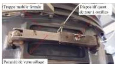
Figure 9 : Trappe mobile verrouillée
