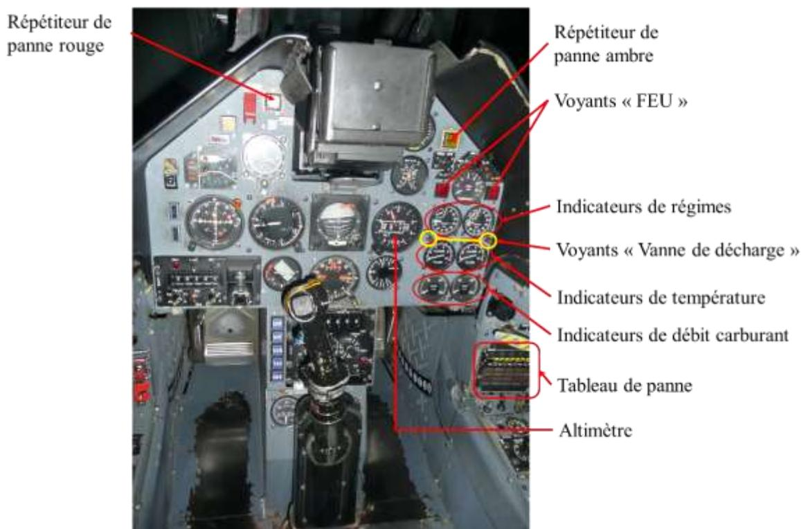
Figure 15 : Visualisation de la planche de bord avant
