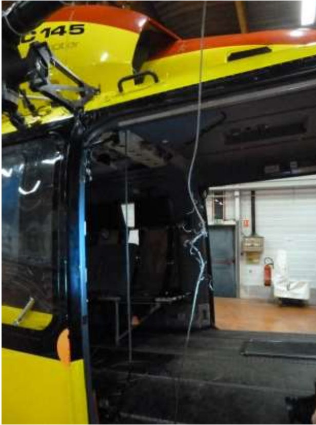
Forme du câble après choc avec une pale
