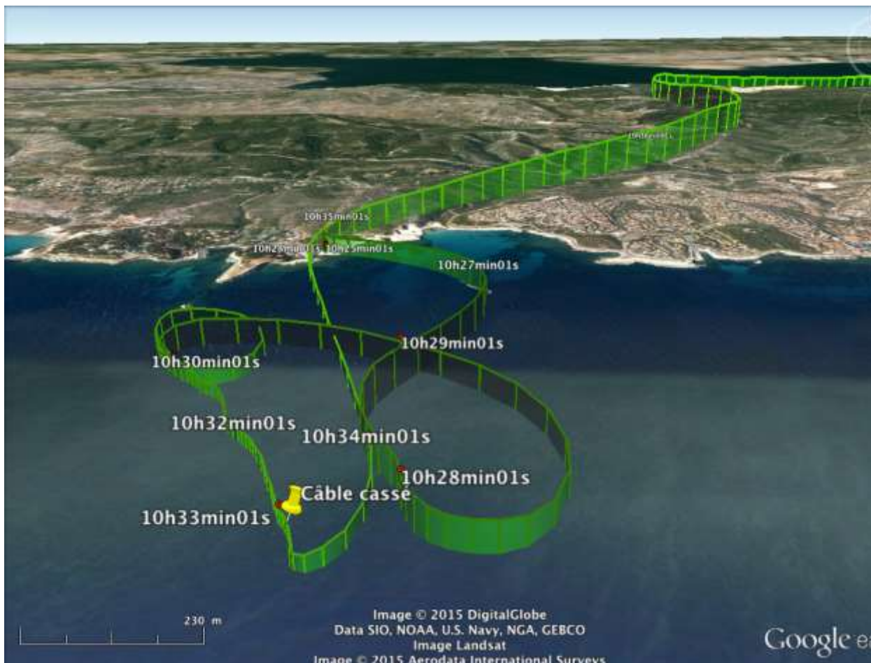
Reconstitution de la trajectoire de l'EC 145 effectuée à partir des enregistrements du CVFDR 1
