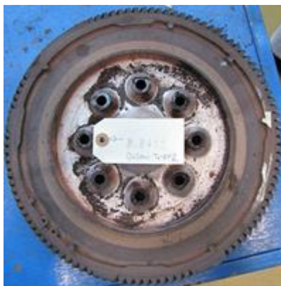
Absence d'aubes autour du disque du deuxième étage de la turbine
