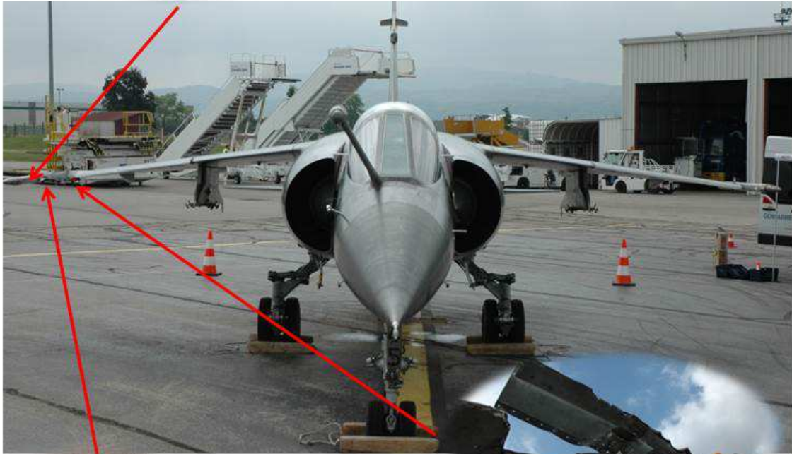
Feu de navigation droit inférieur arraché
