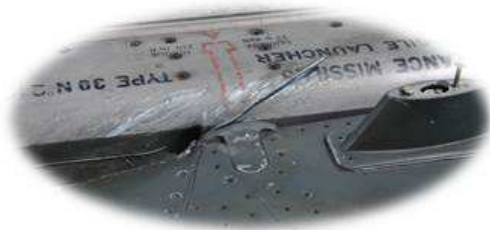
Marquage prononcé d'un fil de la ligne à haute tension sur le lance missile droit
