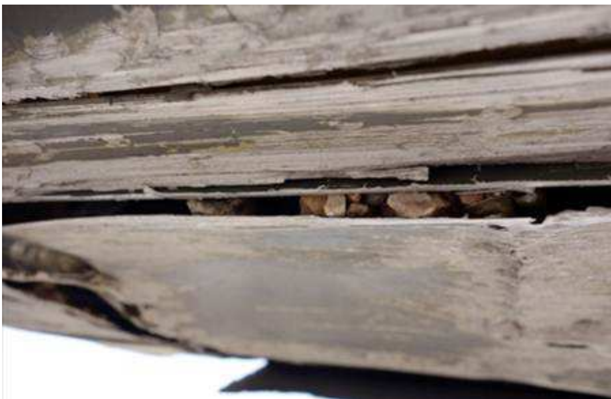
Vue mettant en évidence la présence de cailloux coincés dans les tôles du saumon droit
