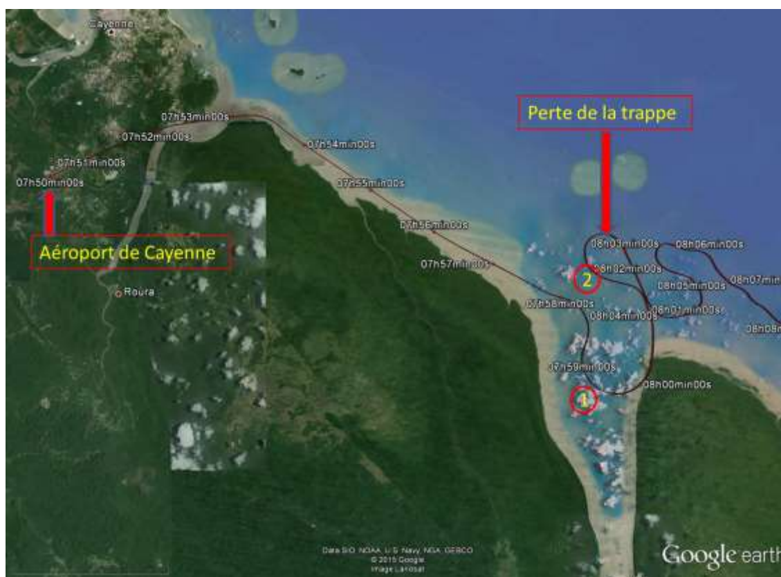
Reconstitution de la trajectoire de l'aéronef du décollage jusqu'à la perte de la trappe
