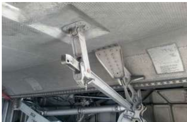
Vue du support central en forme de levier articulé (rodassy) en position porte ouverte
