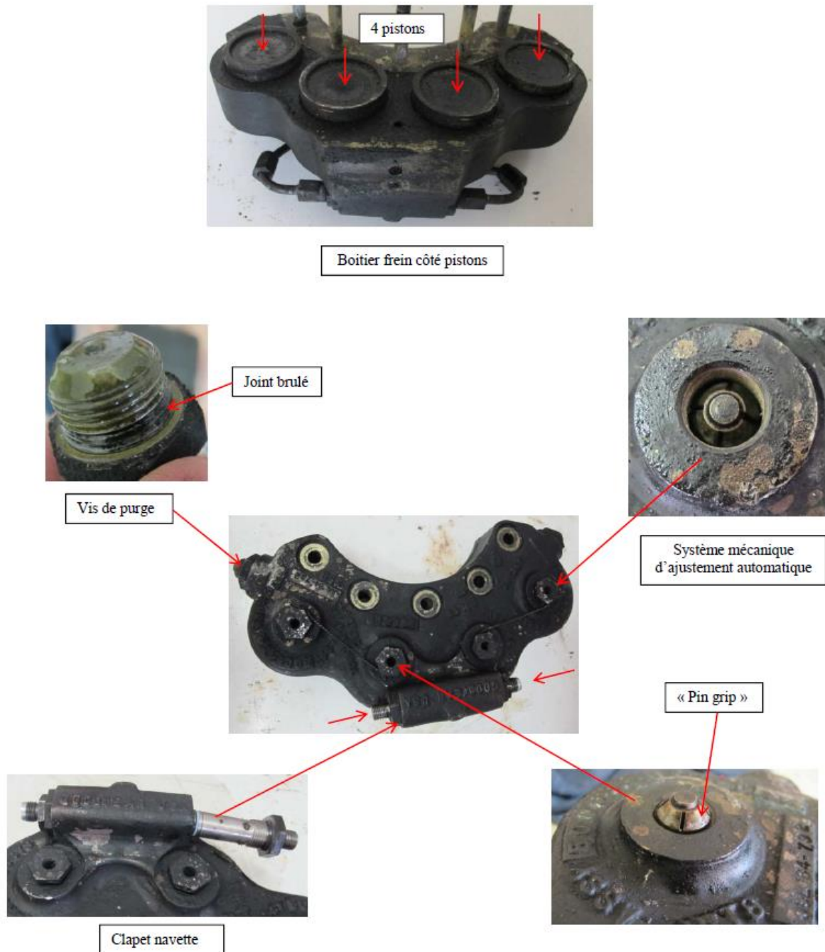
Démontage du boitier de frein gauche du CASA 212-300 n°378
