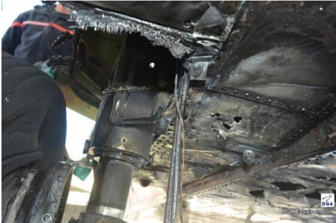
Vue des conséquences de l'incendie sous plancher
