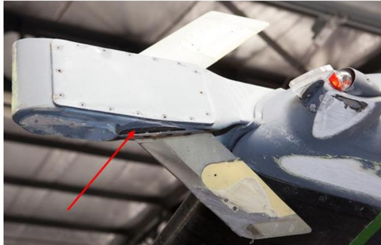
Arrachement partiel de la partie inférieure de l'antenne VHF
