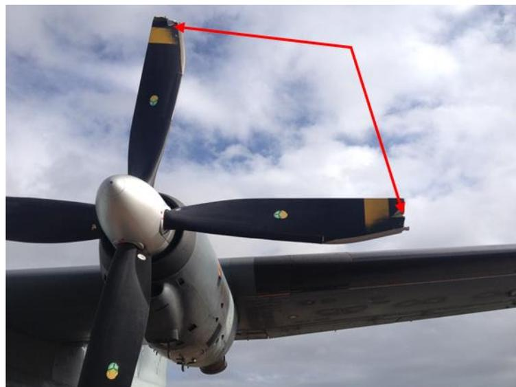
Détérioration des 4 pales de l'hélice gauche
