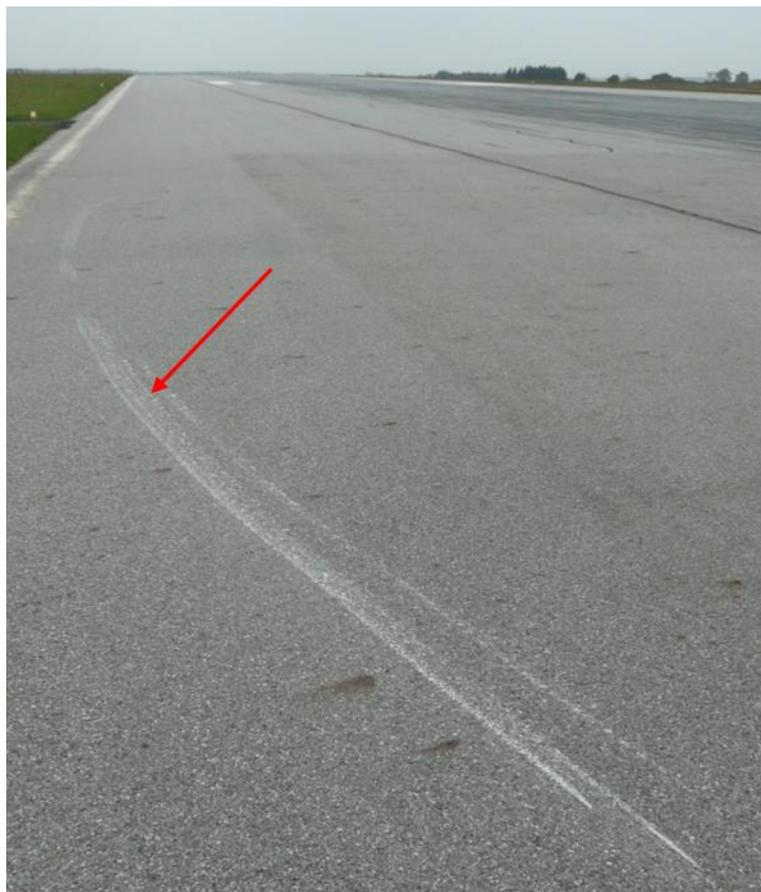
Marque de frottement du saumon de l'aile gauche ainsi que de la partie inférieure de l'antenne VHF
