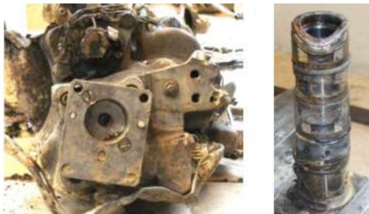
Aspect du régulateur secours et boisseau
