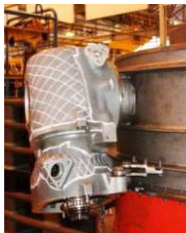
Représentation sur une PMA des parties manquantes des carters (hachurés à la craie)
