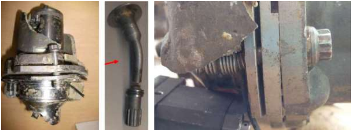
Aspect de la pompe de secours carburant ; de l'arbre d'entraînement et des liaisons sur la PMA
