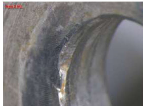
Plateau PMA trou n°2 vu de l'arrière
