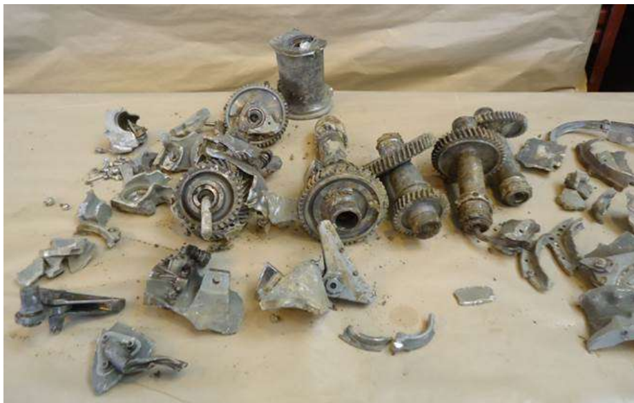
Débris du relais d'accessoires
