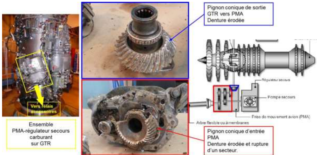
Positionnement de la PMA sur le GTR et endommagements des pignons coniques
