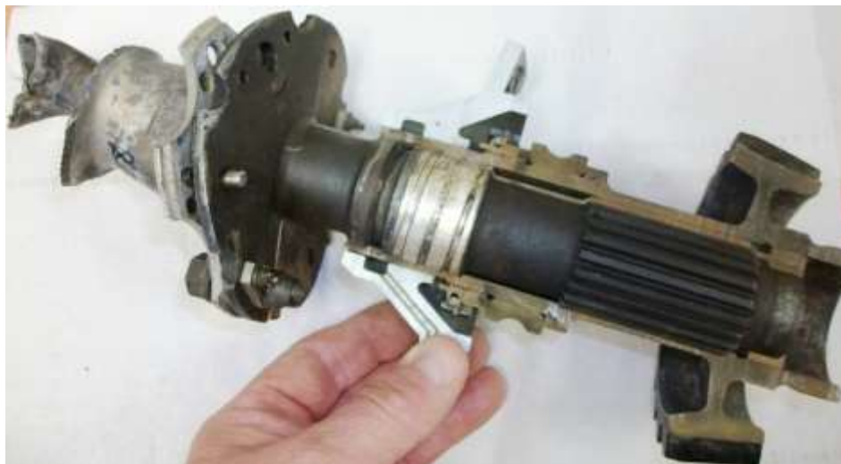
Arbre télescopique d'entrée du relais avion
