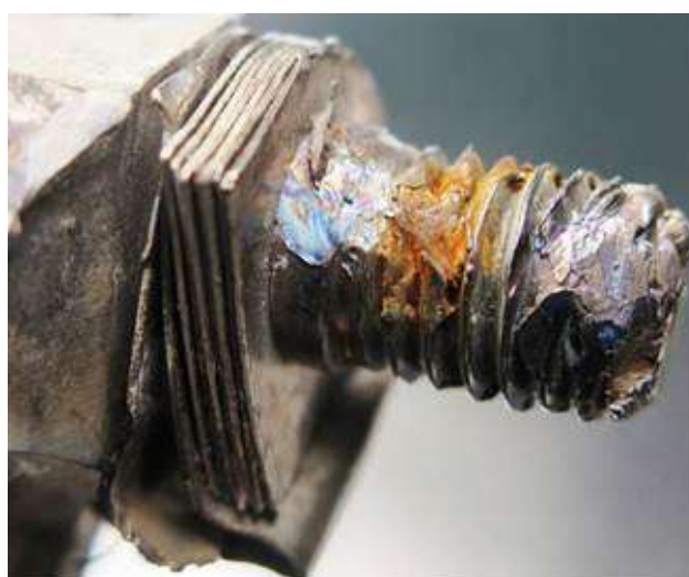
Vis de fixation flector (écrou manquant après dévissage)
