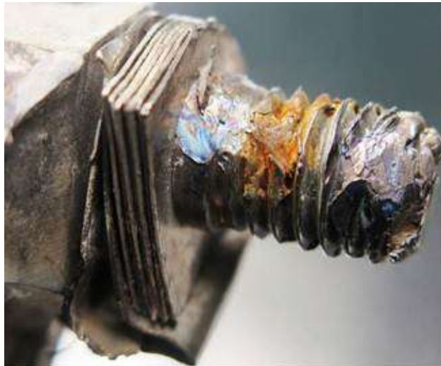
Endommagements sur la vis de la liaison « flector » côté relais (écrou manquant)
