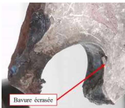
Trou n°1 vu de l'arrière (face de contact)
