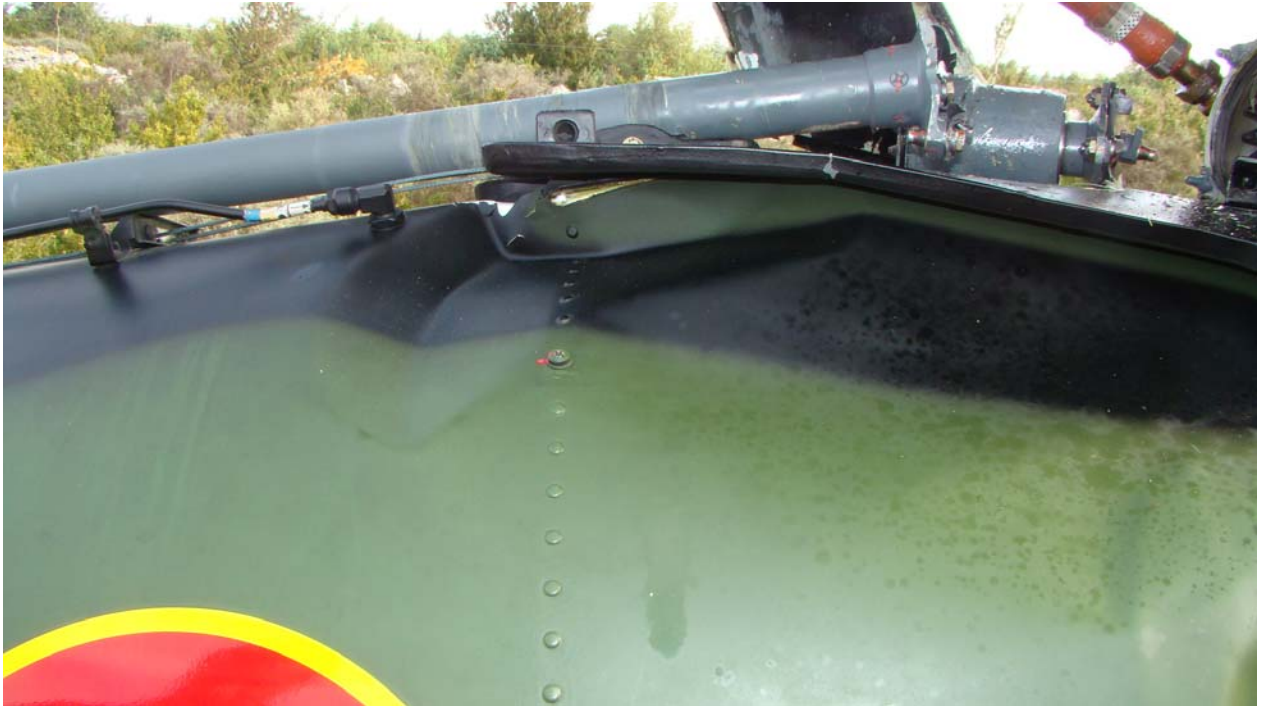
Arbre de transmission arrière désolidarisé
