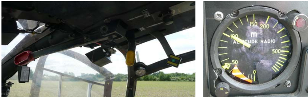
Position de commandes et indication du radioaltimètre
