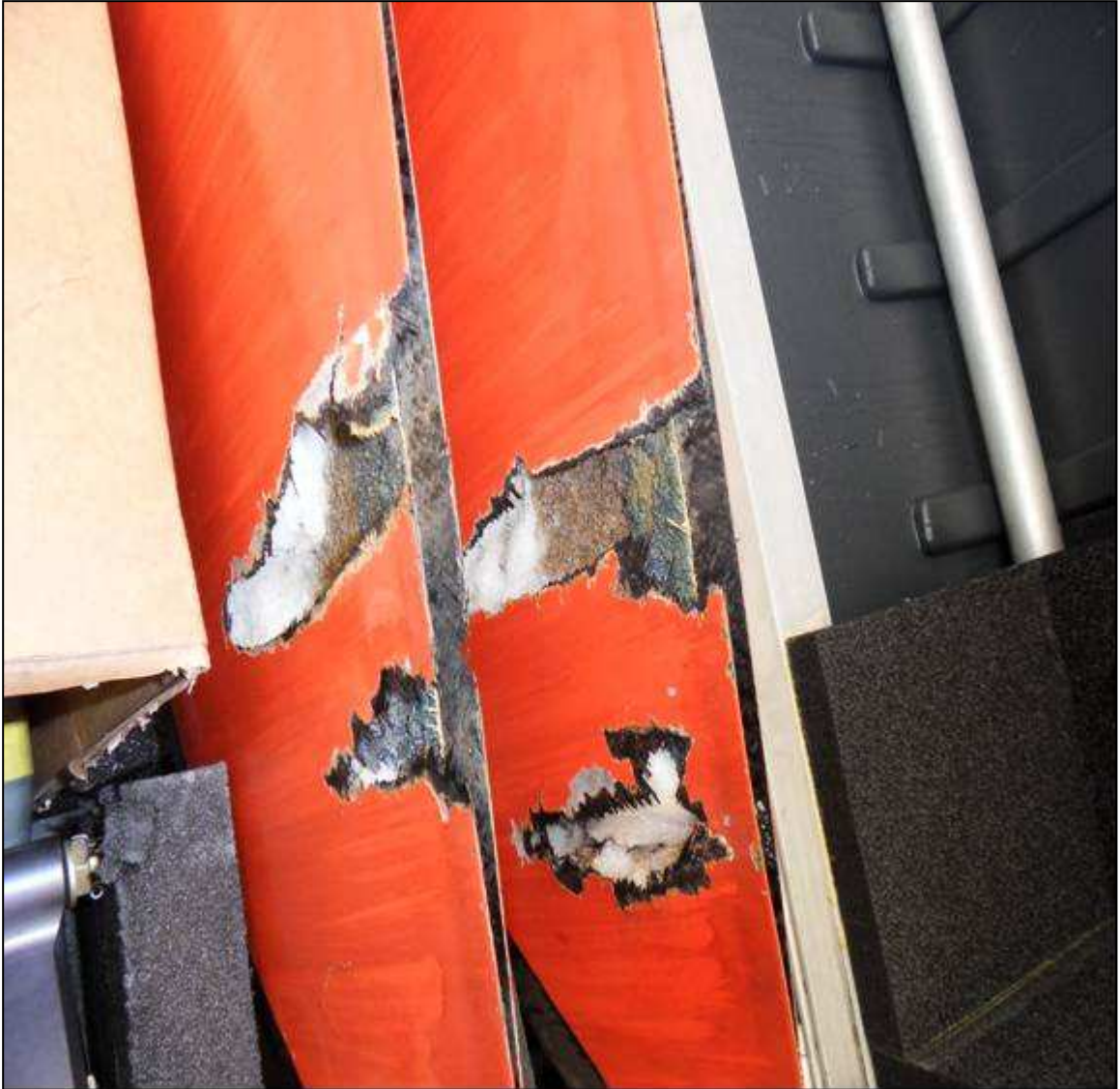
Délaminage des bords de fuite
