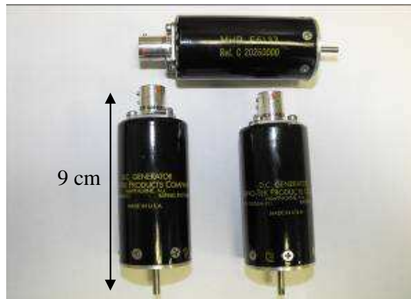
Aspects des 3 génératrices tachymétriques installées sur l'appareil
