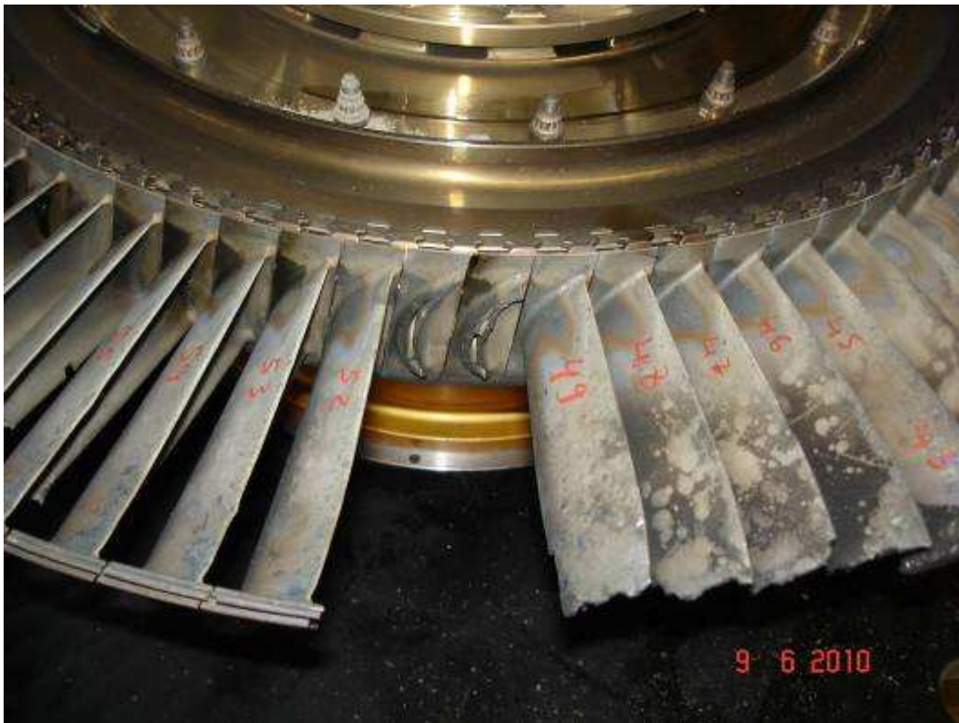
Aubes de turbine rompues et endommagées
