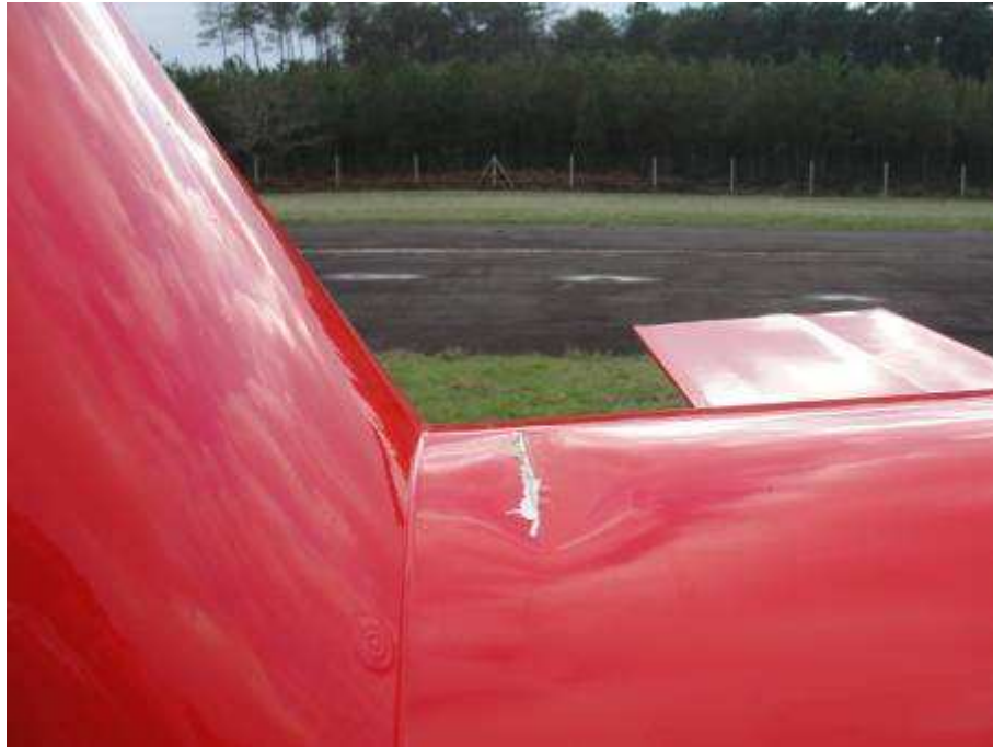
Contact pales-poutre de queue en janvier 2010 – Calliopé n°1568
