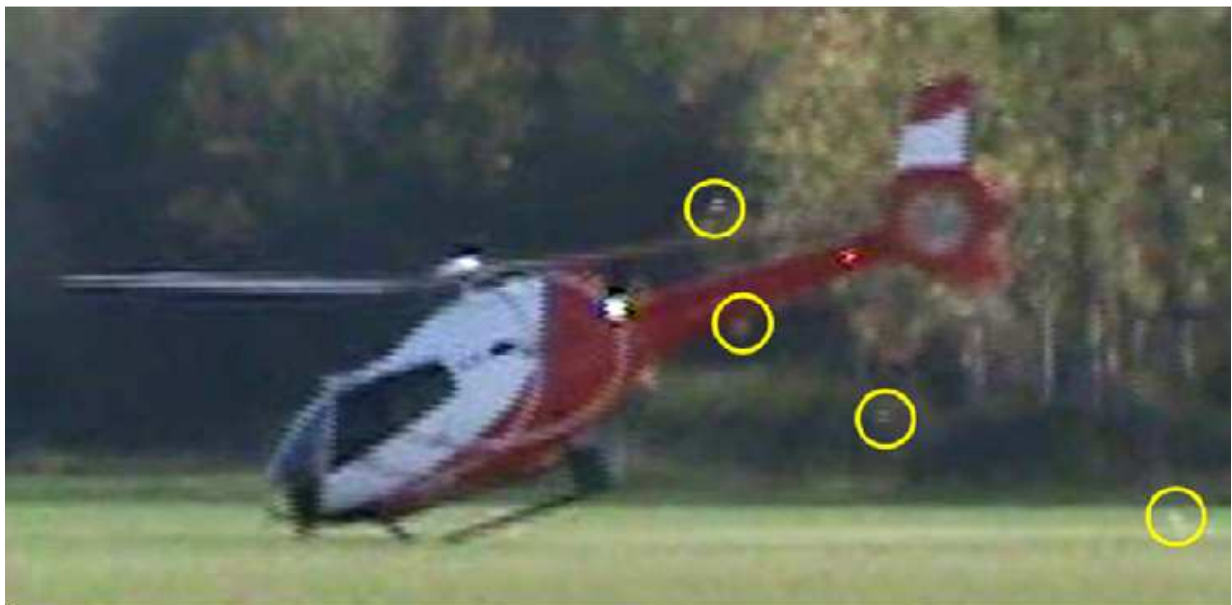
Visualisation de débris de la poutre de queue
