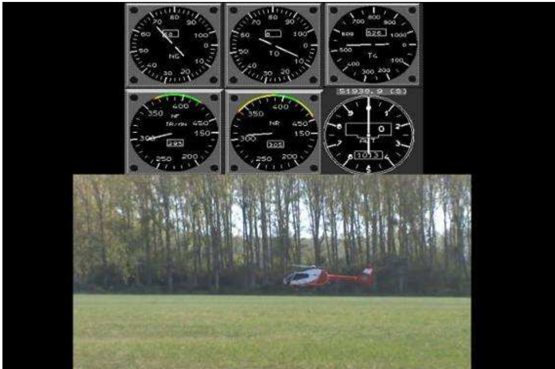
Fin de remise à plat (temps 51938.9 sec ; H≈ 1 mètre ; NR= 305 tr/min)
