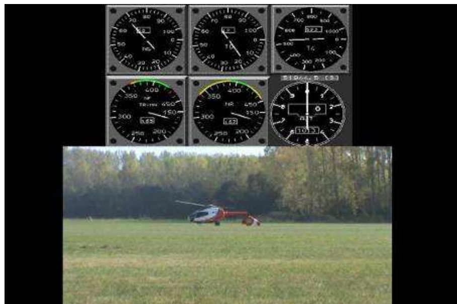
Appareil immobilisé (temps 51944.5 sec ; NR= 167 tr/min)
