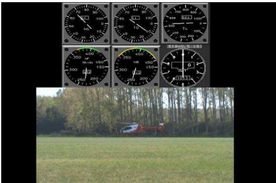
Sommet du rebond (temps 51940.5 sec ; H≈ 1 mètre ; NR= 242 tr/min)
