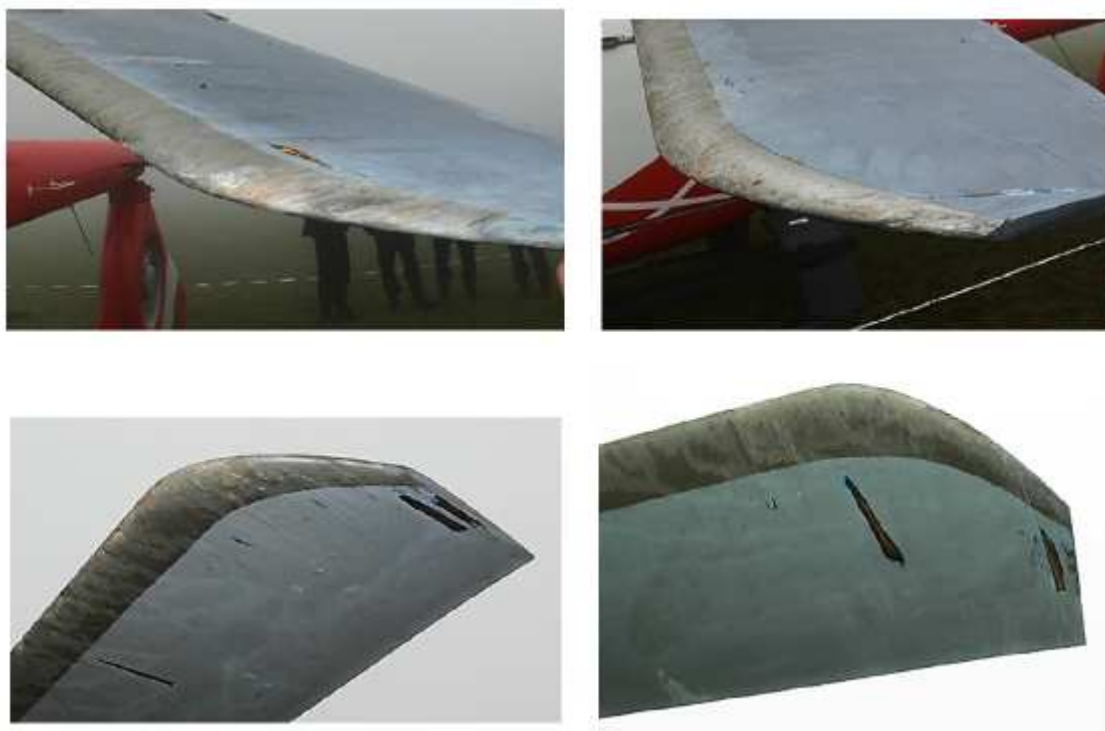
Craquelure en extrados pale bleue (en haut à gauche) et entames sur les trois pales principales
