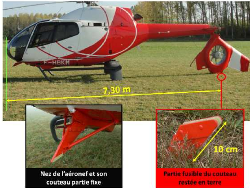
Positionnement longitudinal de la partie rompue du coupe-câble inférieur, fichée dans le sol
