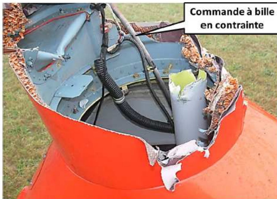
Vue du sectionnement de la poutre de queue, côté fenestron
