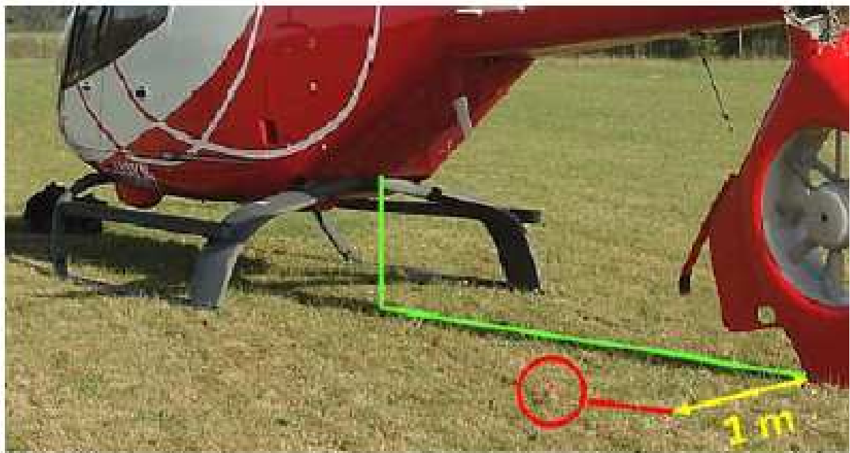
Positionnement latéral de la partie rompue du coupe-câble inférieur
