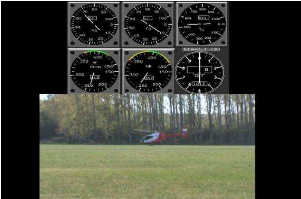
Couple à piquer maximal après le premier toucher (temps 51940.1 sec ; NR= 257 tr/min)
