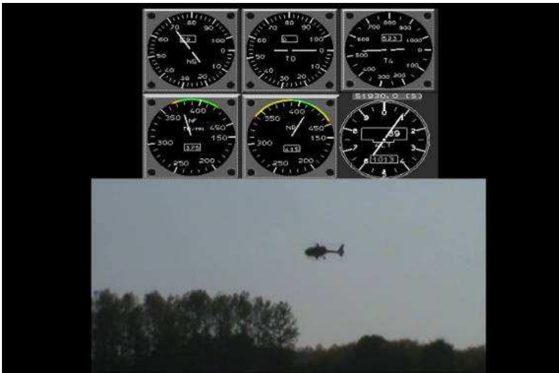
Début de flare (temps 51930 sec ; H \approx 30 mètres ; NR = 415 tr/min)
