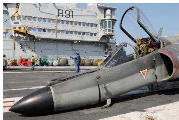
SEM n°24 reposant sur la trappe du train auxiliaire et sur le radome
