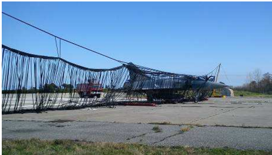
Vue de l'appareil immobilisé dans la barrière d'arrêt
