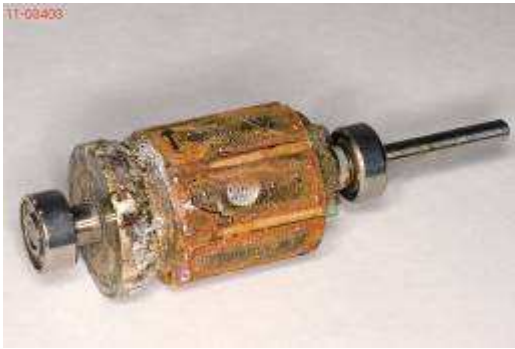
Etat d'endommagement de la génératrice tachymétrique n°1641
