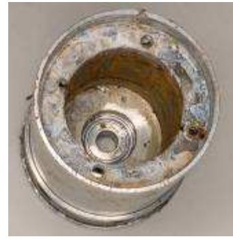
Etat d'endommagement de la génératrice tachymétrique n°1641
