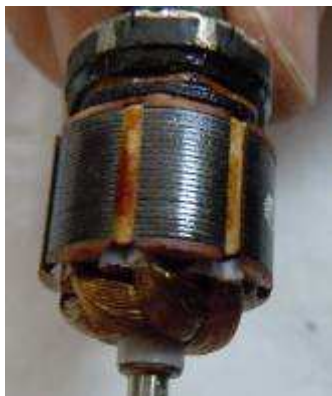
Etat d'endommagement du rotor (à gauche) et de la carcasse (à droite)
