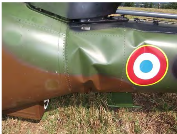
Flambage à la jonction de la poutre de queue
