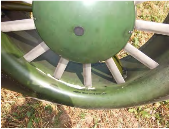
Veine d'air du fenestron marquée
