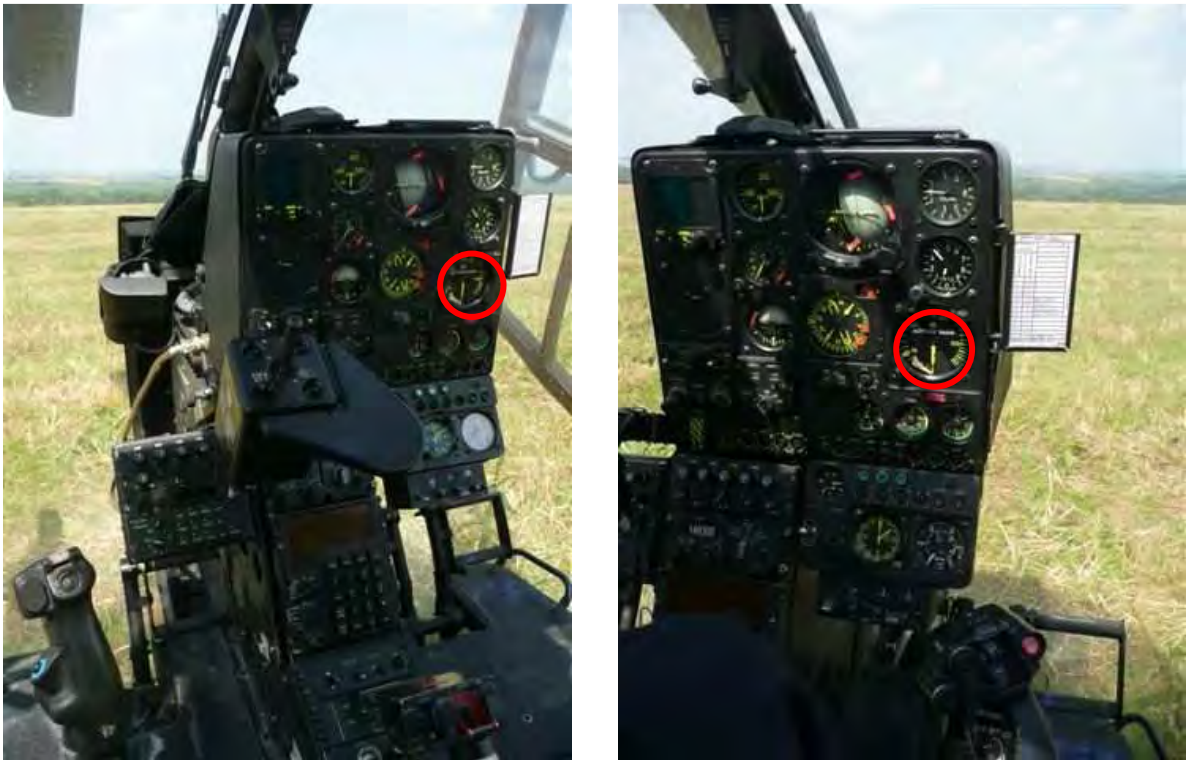
Planche de bord et position de l'indicateur radiosonde vus du poste CDB (à gauche) et du poste pilote (à droite)
