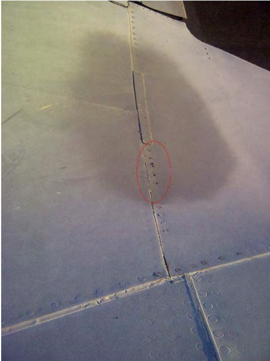
Têtes cassées de rivet extrados karman arrière droit
