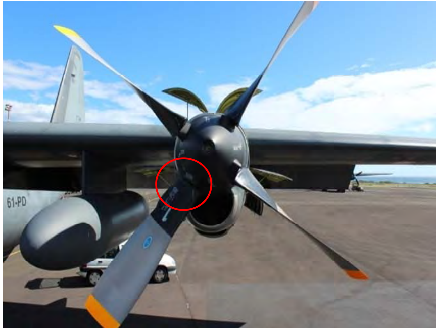
Vue du décalage de la pale 1 du moteur 1
