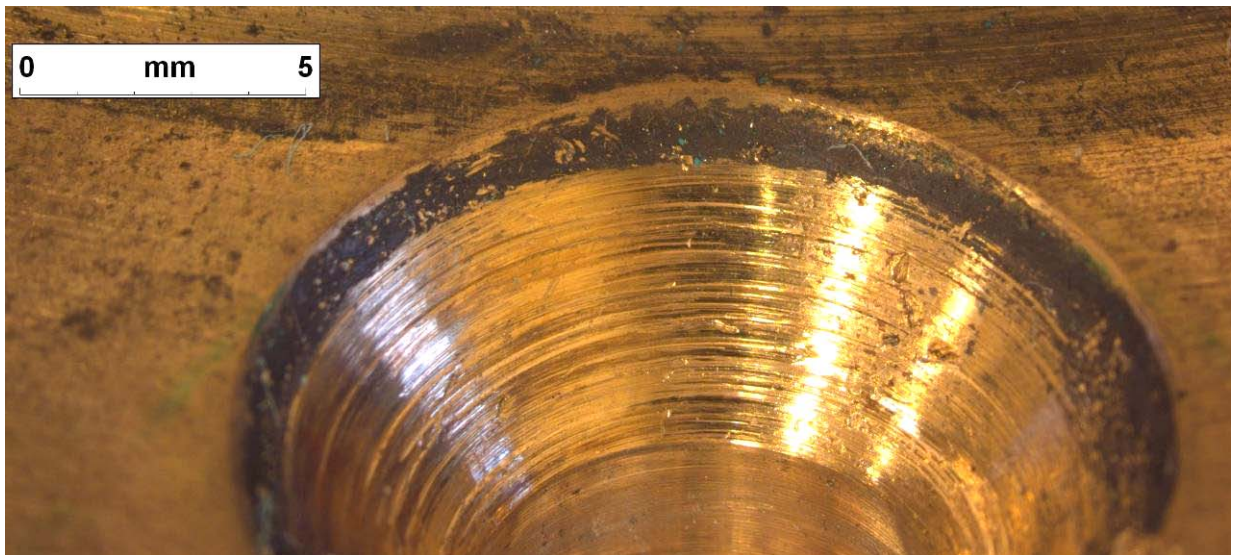
Alésage du bushing de la pale 1 recevant la vis repérée 3
