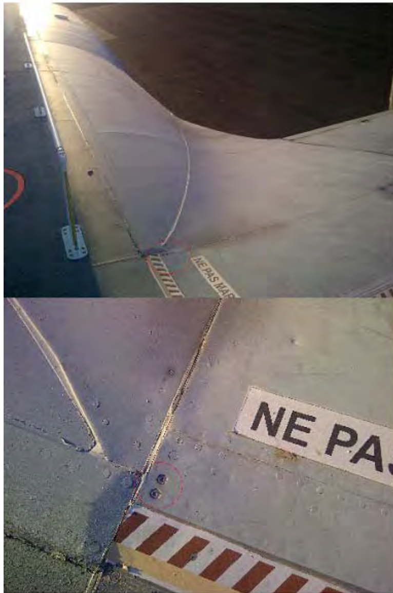
Rivets flottants extradors karman arrière gauche
