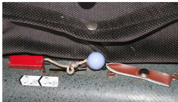
Commande du parachute frein
