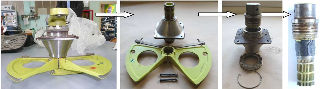
Étapes du démontage et extraction de l'axe de la traversée étanche
