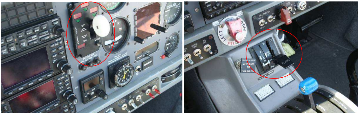
Commande des trains (photo de gauche) et des volets (photo de droite)
