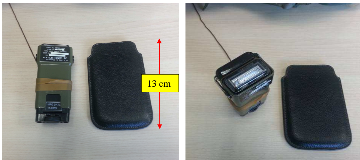
Vue de la lampe IR utilisée pour le marquage
