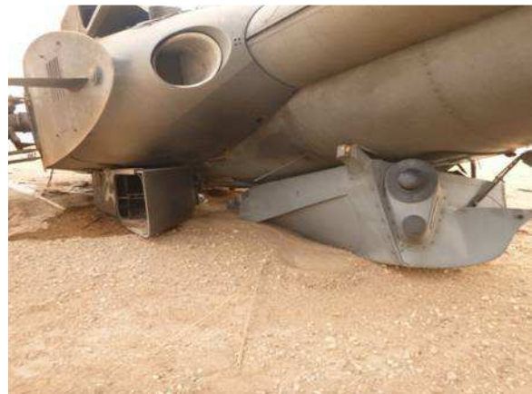
Vue du balconnet écrasé et arraché
