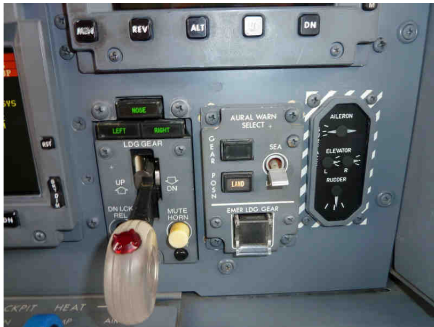
Vue des boîtiers de commande-signalisation et de sélection d'alarme sonore train
