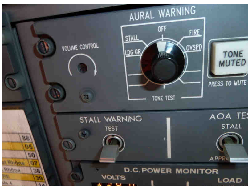
Vue du panneau d'essais des alarmes sonores
