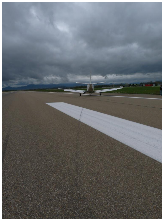
Trace d'abrasion et position finale de l'appareil
