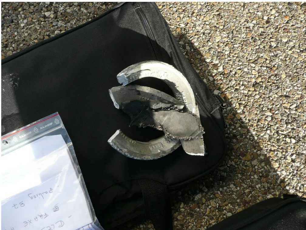
Débris de la jante et du pneumatique du train avant
