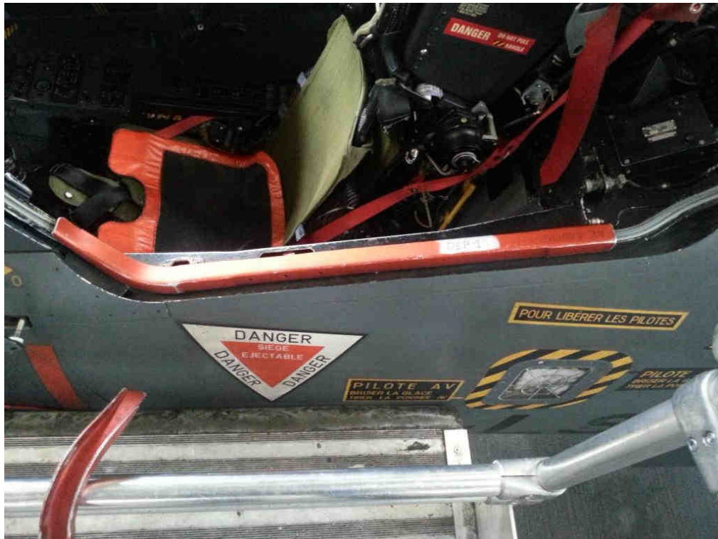
Protection de boudin mise en place lors de travaux en atelier
