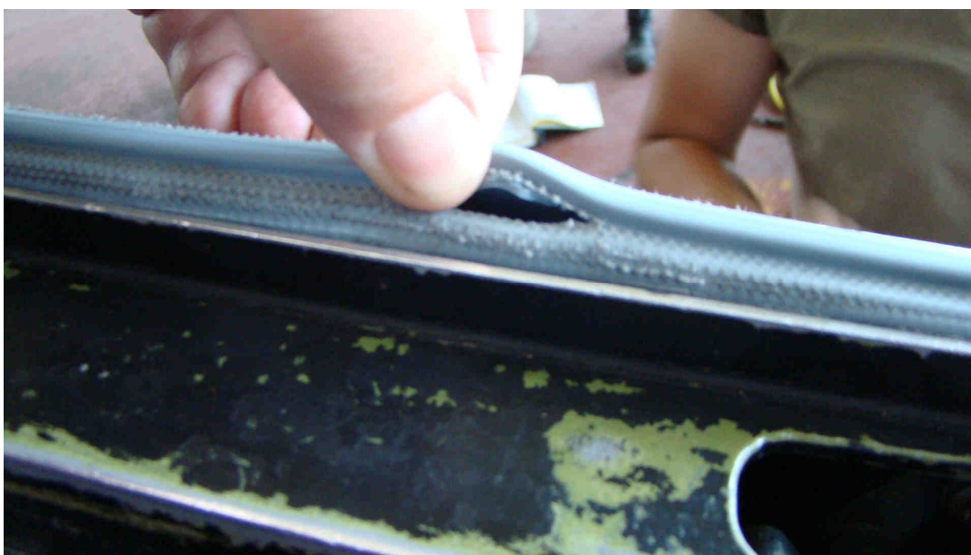
Vue de la zone entaillée sur le boudin autogonflant avant AJET E127
