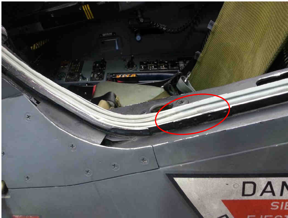
Positionnement de la déchirure du boudin (avant dépressurisation du 8 novembre 2012)
