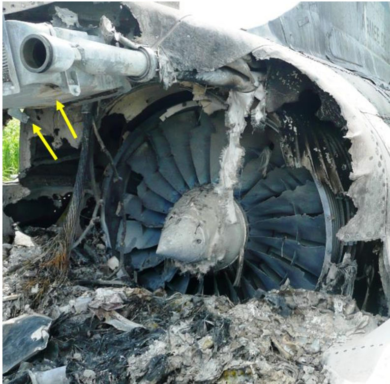
Morceaux restants de la virole d'entrée d'air
