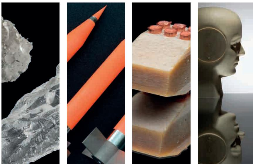
De gauche à droite : nanocristaux explosifs produits par évaporation flash sous vide, modèle de munitions guidées, sabots pour projectiles de canon électrique, modèle de tête pour étude de protection contre le bruit.
