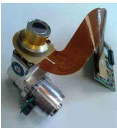
Démonstrateur technologique d'un bloc de détection infrarouge SWAP optimisé en température de fonctionnement (et donc en cryogénie)
