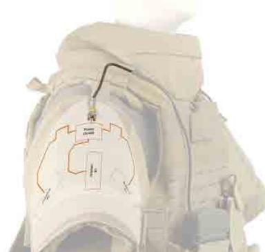
Gilet tactique réalisé en tricotage 3D intégrant une antenne performante de nouvelle génération
