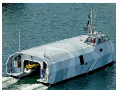
Drone de surface "Sterenn Du" configuré avec un drone sous-marin
