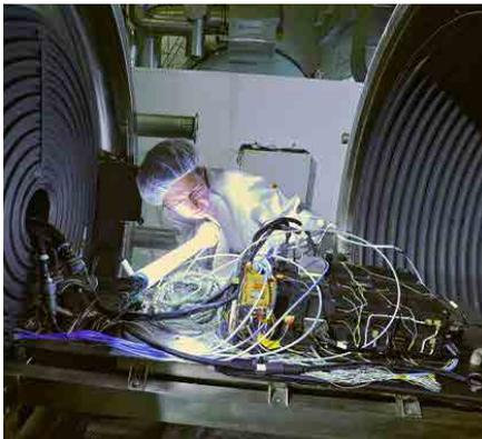
Intégration des boîtiers électroniques du démonstrateur ELISA dont l'objectif est de préparer le programme opérationnel ROEM, devant caractériser techniquement et cartographier des radars et émetteurs de transmission dans le monde entier. (© CNES/GRIMAUULT Emmanuel, 2010)
