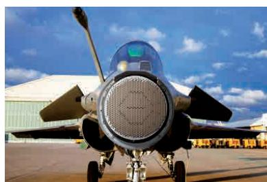
Radar RBE2 à antenne active équipant un avion Rafale
